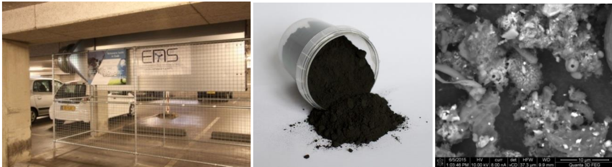
Figuur 3 - Links: toepassing Aufero unit in Parkeergarage; midden: afgevangen fijnstof dat in de Aufero is getransformeerd tot niet-inadembaar grofstof; rechts: microscoopopname van afgevangen stof, waarin de samenvoeging van kleine deeltjes tot grote clusters waarneembaar is.
